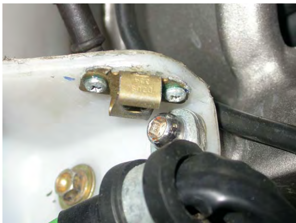
Côté droit – Détail de la fixation AV par vis
